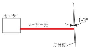
図 27: 反射板の取り付け
